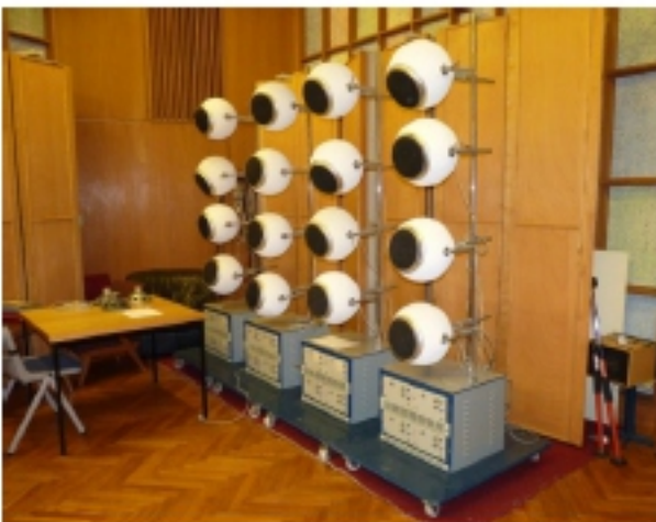
Bild 9.40. Hörspielstudio H 2/1, Holzverkleidung gegenüber Sprechertisch. (mit Lautsprecher-Arrays für künstliches Schallfeld zur Kunstkopf-Aufnahmetechnik) (Foto: G. Steinke 2010).
