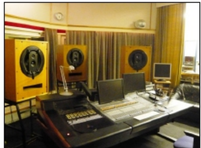
Bild 9.37.C. Das neue Digital-Regiepult von H 2. - und auf der linken Pultseite mit den noch immer gern genutzten historischen Analog-Vorverstärkern aus der V 700-Technik - mit ihrem sagenhaften Störspannungsabstand!
